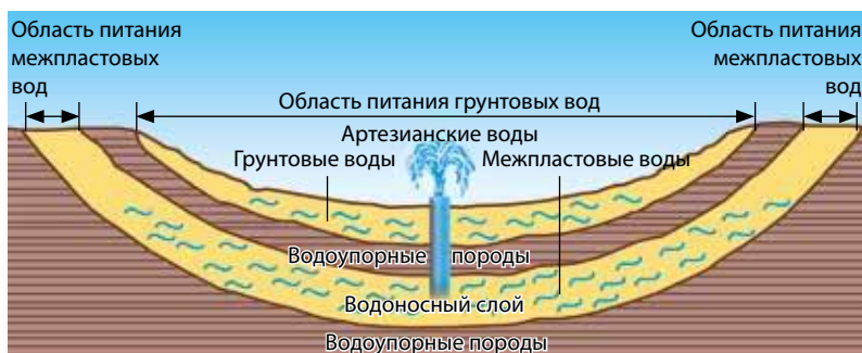
Рис. 117. Залегание подземных вод
